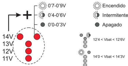
3.- ESTADO DE LOS RELÉS DE PANEL Y CONSUMO: comprueba el estado de los relés de panel y consumo. Se encenderán los indicadores L2 y L4 para advertir que se encuentra en esta fase. El indicador de CONSUMO (L1) y el de PANEL (L5) se activarán fijamente confirmando que el equipo funciona correctamente y parpadearán para avisar que convendría revisar las conexiones. El indicador de PANEL (L5) no se encenderá si es de noche.
